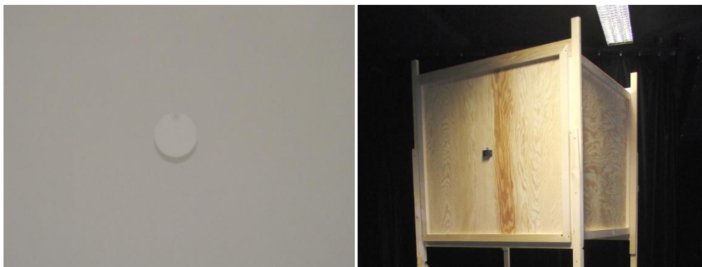
Obr. 34: Pohled zevnitř – stínítko v integrátoru, pohled na integrátor zezadu – držák fotočlátku
