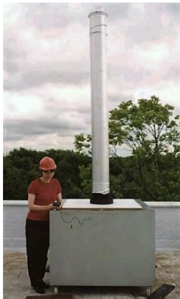
Obr. 22: Měření světlovodu ve venkovním prostředí [U]
