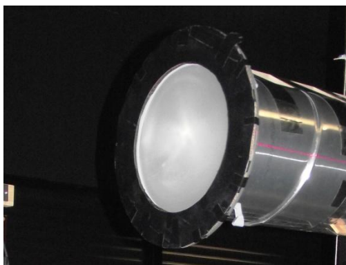
Obr. 40: Difuzor JustFrost se zacloněním skleněného okraje
