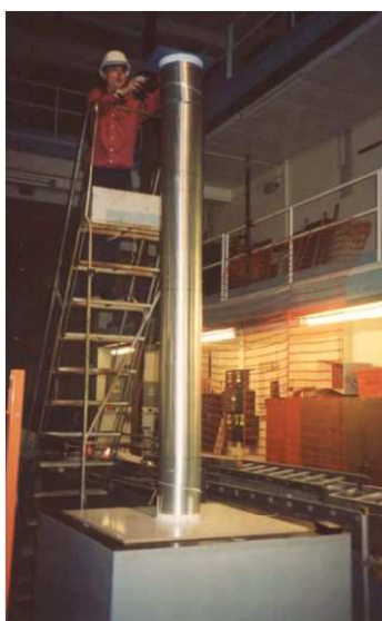
Obr. č. 7 – Instalace fotočlánku k následnému změření osvětlenosti v rovině hrdla pod simulovaným slunečním světlem
