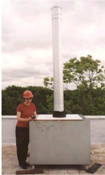
Obr. č. 4 – Světlovod při měření
