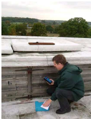
Obr. č. 5 – Simultánní měření globální horizontální osvětlenosti při použití druhého luxmetru
